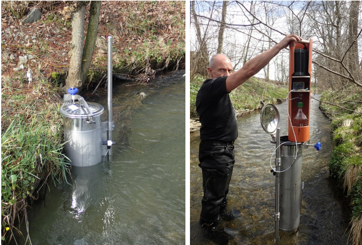
Abb. 5: Sampler zur Entnahme von zeitproportionalen Mischproben aus kleinen Fließgewässern.
