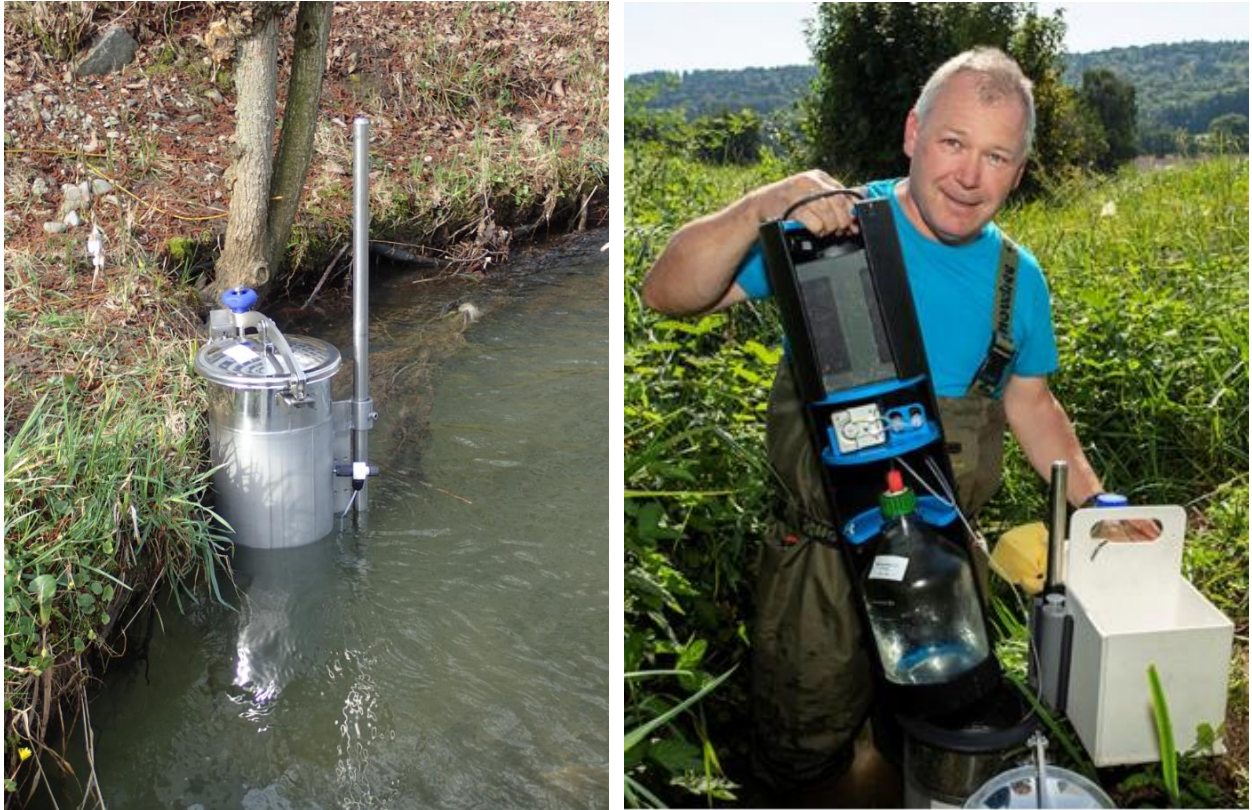
Abb. 5: Sampler zur Entnahme von zeitproportionalen Mischproben aus kleinen Fließgewässern.
