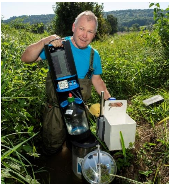
Abb. 1: Mischprobensammler für kleine Fließgewässer
