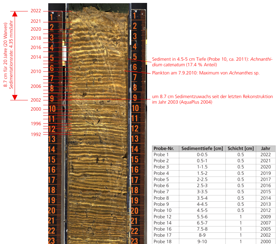
Abbildung 3.1: Sedimentkern GRE22-06B des Greifensees im oxidierten Zustand mit Angaben zur Datierung (Zählung der Warven) und Hinweise aus den Planktonzählungen der EAWAG. Beprobte wurde die andere Hälfte des Kernes (GRE22-06A).
