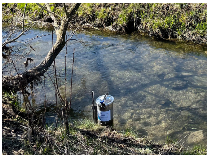
mobiler Mischprobensammler im Mülibach
