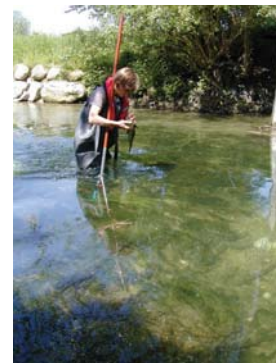
Abb. 9: Probenahme an der Glatt im Kanton Zürich. Makrophyten werden mit Hilfe eines Rechens zur näheren Bestimmung entnommen.
