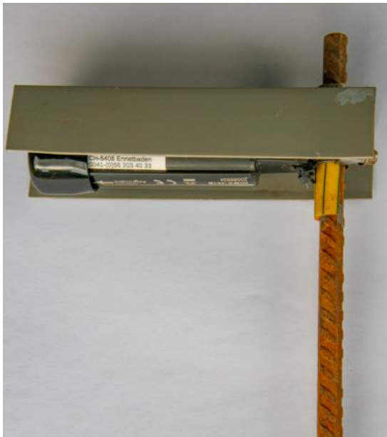
Abbildung 13: Am Metallstab befestigter Datenlogger mit Sonnenabdeckung.
