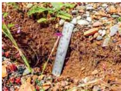
Mindestens zehn Zentimeter (verdichtetes) Qualitätssubstrat. Quelle: GSZ
