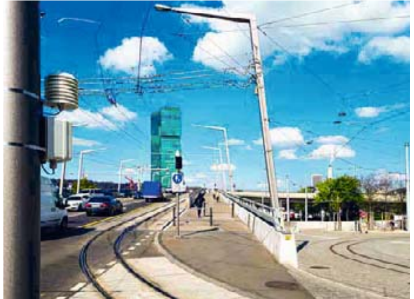
Montierter Lufttemperatur- und Luftfeuchtesensor (am linken Bildrand) am Hardplatz in Zürich. Quelle: AWEL
