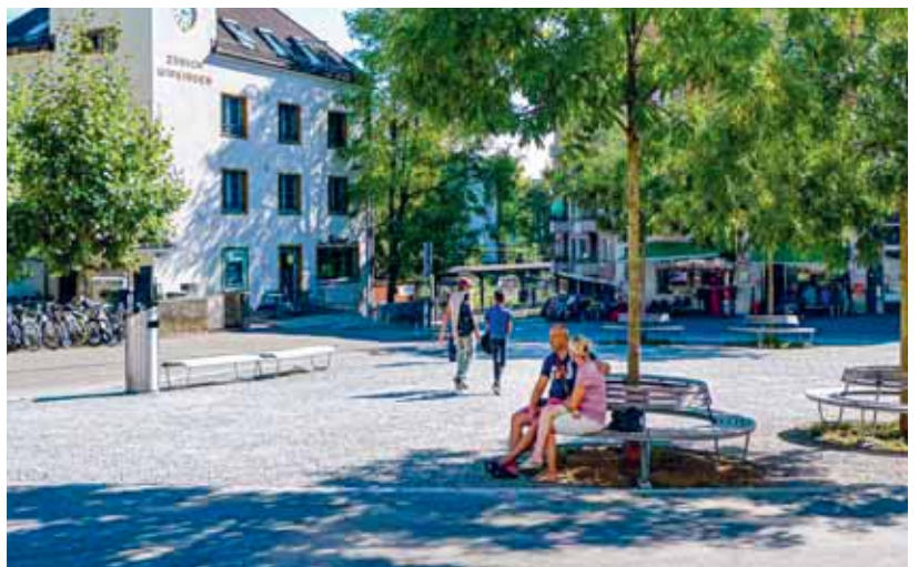
Wipkingen bekam 2014 infolge der Umgestaltung des Röschibachplatzes einen neuen, klimaökologischen Quartierplatz mit sickerfähiger Deckschicht aus hellem Kies sowie Baumpflanzungen. Quelle: Stadt Zürich
