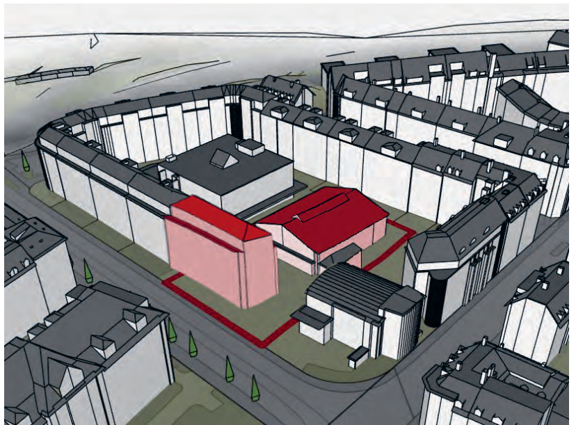
Der Neubau bildet das letzte Stück einer Blockrandsiedlung aus den 1930er-Jahren. Beide Gebäude sind über eine unterirdische Einstellhalle miteinander verbunden. Quelle: EK Energiekonzepte
