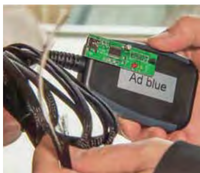
AdBlue-Manipulationsgerät. Quelle: SRF
