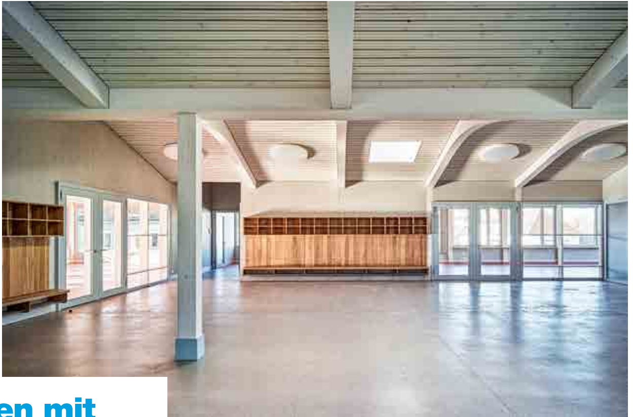
Das Schulhaus für Kindergärten und Tagesbetreuung Lätten in Fällanden stellt ein gelungenes öffentliches Bauprojekt mit vorgefertigten Holzmodulen dar, welches den Minergie-P-Eco-Standard erfüllt.
