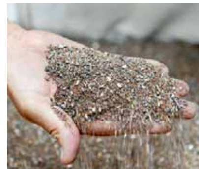
Sortierung von Metallen, die aus KVA-Schlacke gewonnen wurden, KVA Hinwil. Quelle: Keystone
