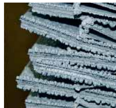
Zinkgewinnung aus der Rauchgasreinigung. Quelle: KEBAG, Zuchwil
