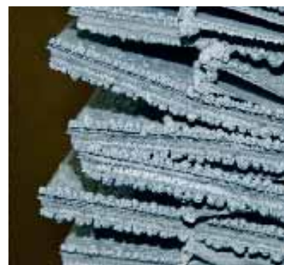
Zinkgewinnung aus der Rauchgasreinigung. Quelle: KEBAG, Zuchwil
