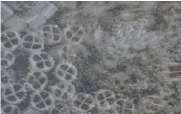
Abb. 12: Aufwuchskörper in einem Wirbelbett-Reaktor. Auf diesen bilden Bakterien einen Biofilm als Behausung.
