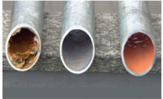
Abb. 4: Dichte und intakte Netzwasserleitungen sind der effektivste und kostengünstigste Ansatz, um Abwasser zu vermeiden. Hier: Korrodierte, gesäuberte und mit Epoxidharz ausgekleidete Wasserrohre. Quelle: SRF.
