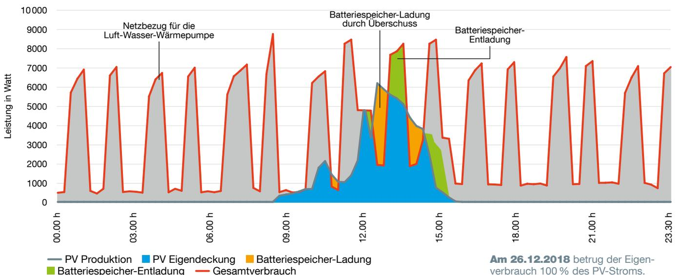
**Am 26.12.2018** betrug der Eigenverbrauch 100 % des PV-Stroms. Die Eigendeckung war gering (rund 15 bis 20 %). Es fand keine Netzeinspeisung statt.
