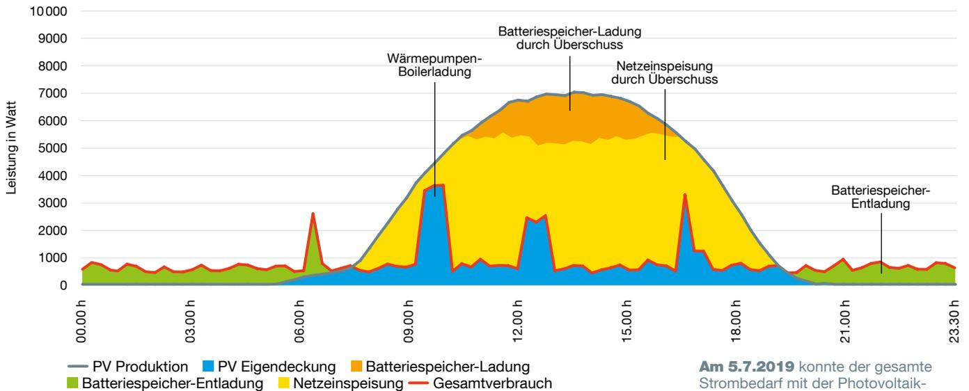
**Am 5.7.2019** konnte der gesamte Strombedarf mit der Photovoltaik-Anlage und dem Batteriespeicher gedeckt werden (100 % Eigendeckung). Es fand kein Netzbezug statt.
