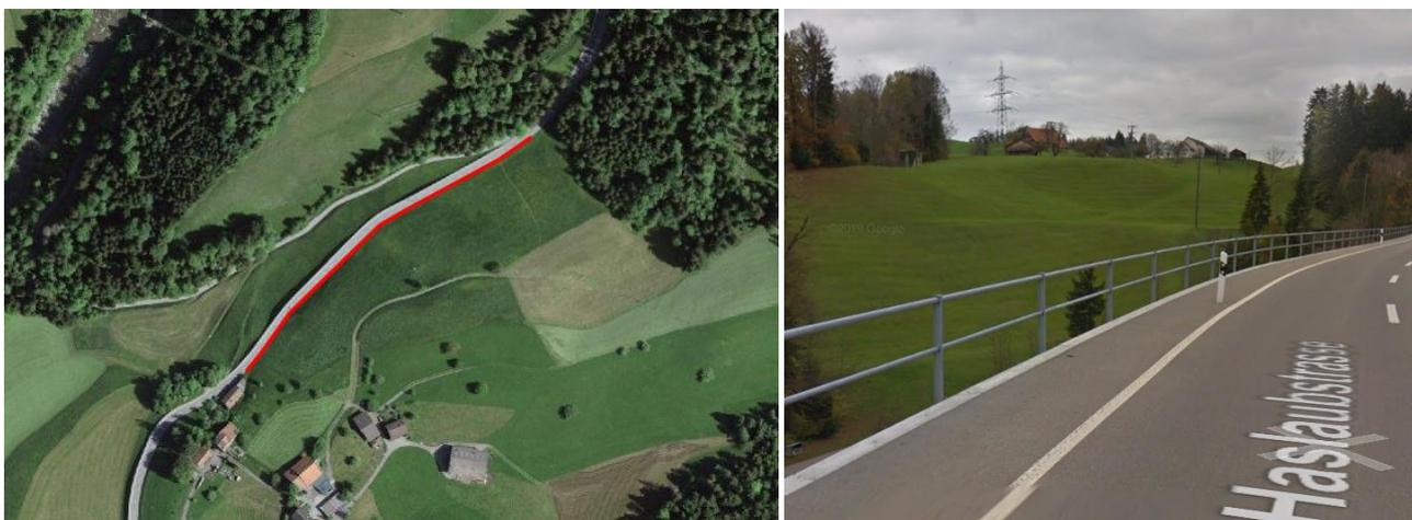
Abbildung 45: Stützmauer Waldhalden an der Haslaubstrasse südlich von Schönenberg links (geo.admin) als rote Linie. Das Objekt befindet sich auf der von der Strasse abgewendeten Seite (rechts) mit Süd-Südöstlicher Ausrichtung (Google Streetview). Es ist 297 m lang und 3 m hoch. Die maximale Modulfläche beträgt 892 m<sup>2</sup>, die Nennleistung bis zu 178 kWp.
