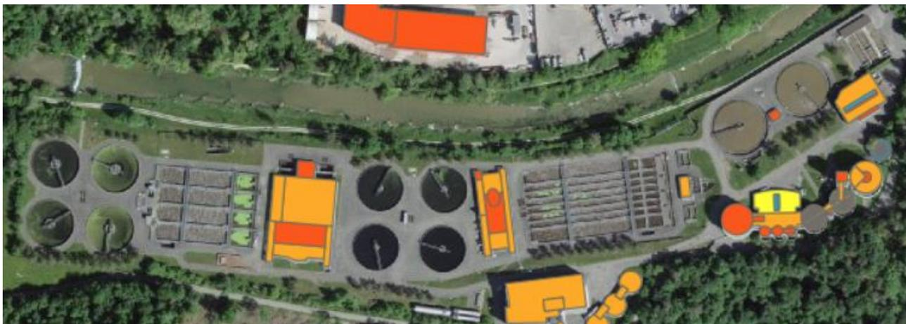
Abbildung 32: Nutzbare Dachflächen gemäss Solardachrechner, Beispiel ARA Hard.
