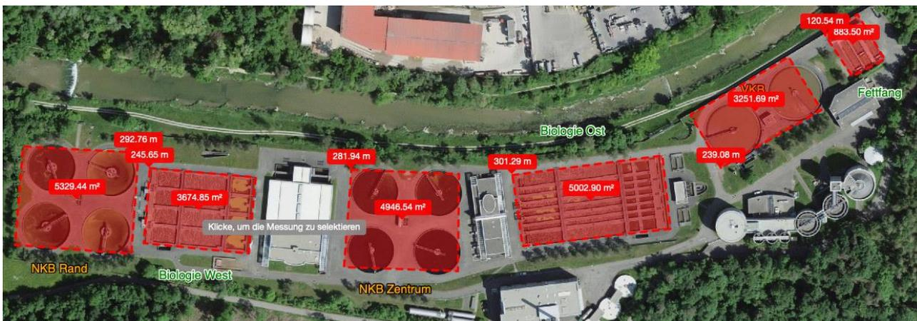
Abbildung 33: Für Faltdachsysteme nutzbare Flächen über den Reinigungsbecken und über weiteren Flächen, Beispiel ARA Hard.
