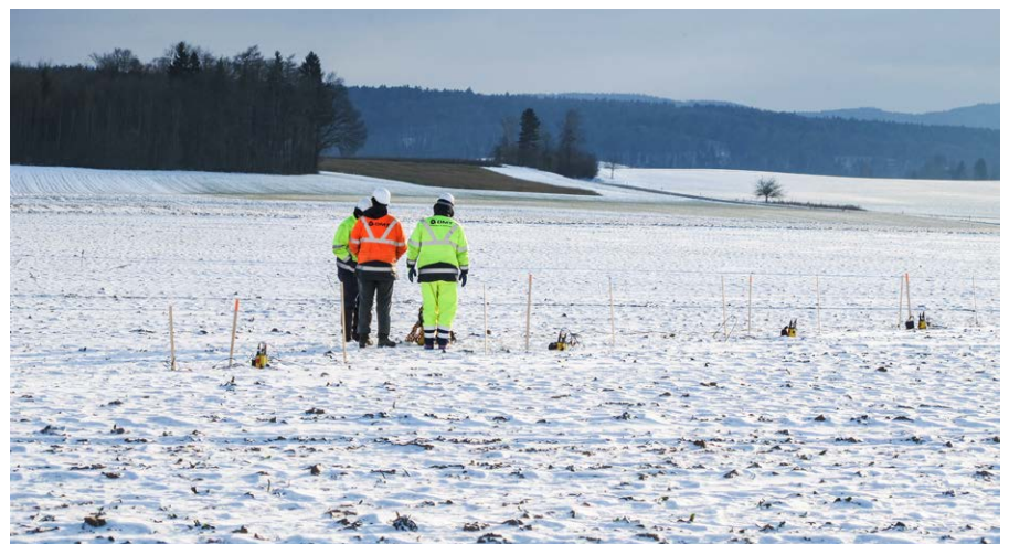
Mit Schusseeismik (kleine Sprengungen im Boden) wird der Untergrund erforscht.
