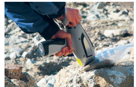
Abbildung 7 Messung des Bleigehalts mit mobiler Röntgenfluoreszenz-Spektrometrie (m-XRF) im Feinanteil der aufbereiteten Probe. Bild: ARV
