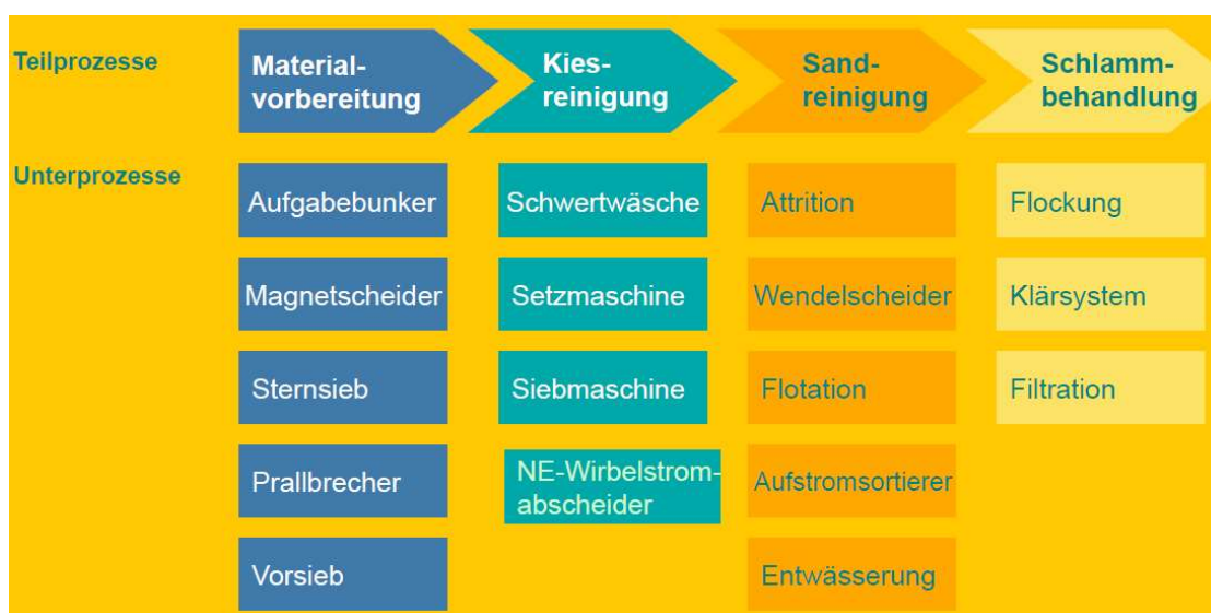
Abb. 34: Aufbereitungstechnik am Beispiel der Erd- und Schotteraufbereitungsanlage Rümlang ESAR (Uni Bern, 2016).
