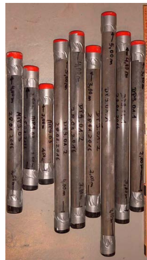
Abbildung 18: Feinkörnigen Feststoffproben mit leichtflüchtigen Stoffen in Kunststoff-Linern
