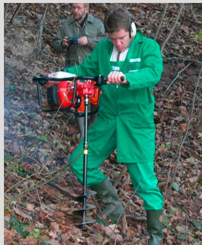
Abbildung 12: Probenahme mit Schneckenbohrer aus einer Abfallablagerung
