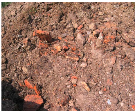
Abbildung 10: Abfallhaltiges Aushubmaterial auf einem Haufwerk
