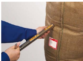
Probenahme aus einem Sack mit Zonensammler
