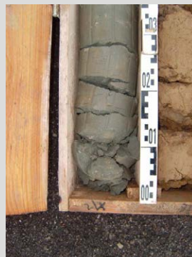
Abbildung 16: Feinkörnige Bohrkern aus einer 4½"-Kernbohrung
