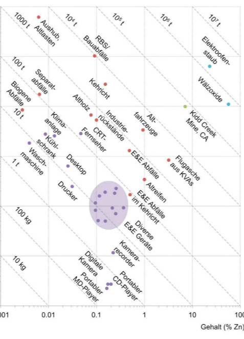
Abb. 5 Tonnage-Erzgehalt-Diagramm für die primäre Produktion in der zinkreichsten Mine der Welt (Kidd Creek, Kanada) (grüner Farbtönen 19,16 ) und sekundäre Zinkressourcen (rot: Altmaterialien Schweiz inkl. Flugasche aus der Kehrichtverbrennung 7,23,24,32 ; violett: Altelektische und -elektronische E&E Geräte weltweit 29 ; hellblau: Filterstaub aus Stahlwerken und Wälzoxiden weltweit 12,4 ). Beispiel als Leseschlüssel: In der Kidd Creek-Mine werden 1'000'000 Tonnen Zinkerz mit einem Gehalt von 7% abgebaut, was 70'000 Tonnen/a reinem Zink entspricht.
