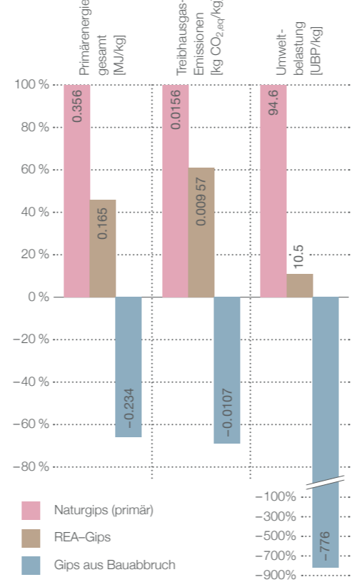
► Abb. 5 Erste Abschätzung der Ökobilanz von primärem (rosa) und sekundärem Gips aus Rückständen der Rauchgasentschwefelung (braun) und aus Bauabbruch (blau) (24). Normiert auf primären Gips (= 100 %). Negative Zahlen entstehen durch die riesigen Vorteile der Vermeidung des Deponierens von gipshaltigem Bauabbruch gegenüber den technischen Aufwendungen.
