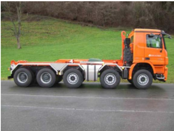
Abbildung 9: 5-Achs-Fahrzeug mit Abroll- und Hubhaken
