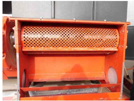
Abbildung 39: Schneidsieb 10 mm Industrieschredder (eigene Darstellung)
