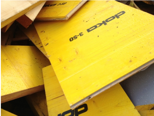
Abbildung 9: Bauschaltafeln (eigene Darstellung)
