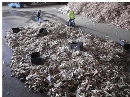
Abbildung 30: Entnahme Probenmaterial mit Schaufel (eigene Darstellung)
