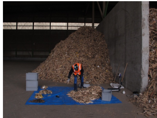
Abbildung 26: Kontrolle Durchmischung (eigene Darstellung)
