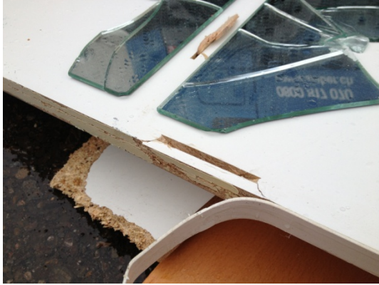
Abbildung 13: Fremdstoffe an beschichteten Holzwerkstoffen (eigene Darstellung)
