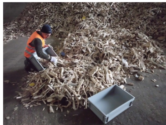
Abbildung 33: Manuelle Entnahme Einzelprobe (eigene Darstellung)
