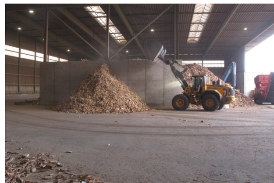
Abbildung 24: Versuchshaufwerk 100 m 3 (eigene Darstellung)
