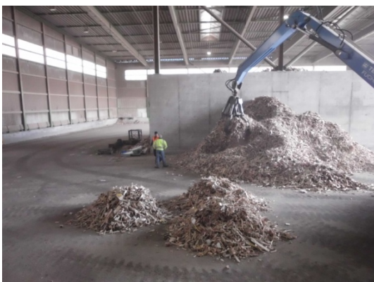
Abbildung 29: Entnahme Altholz mit Greifer (eigene Darstellung)
