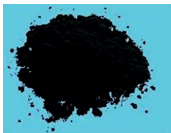
Kein Abfall: Gummimehl und Metallfraktion in Reinform.
