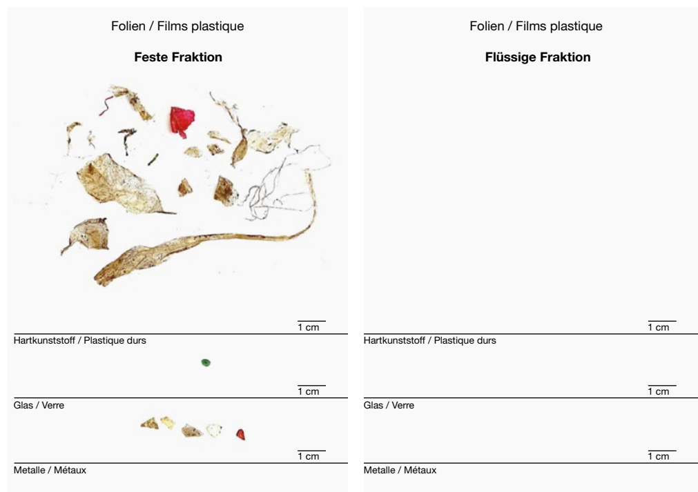
Foto 6: Fremdstoffe in festem und flüssigem Vergärungsprodukt aus Laborberichten: Die Fremdstoffe finden sich in der festen Fraktion wieder, die separierte Flüssigfraktion ist in der Regel fremdstofffrei. Die beiden Analyseergebnisse stammen von der gleichen Anlage.
