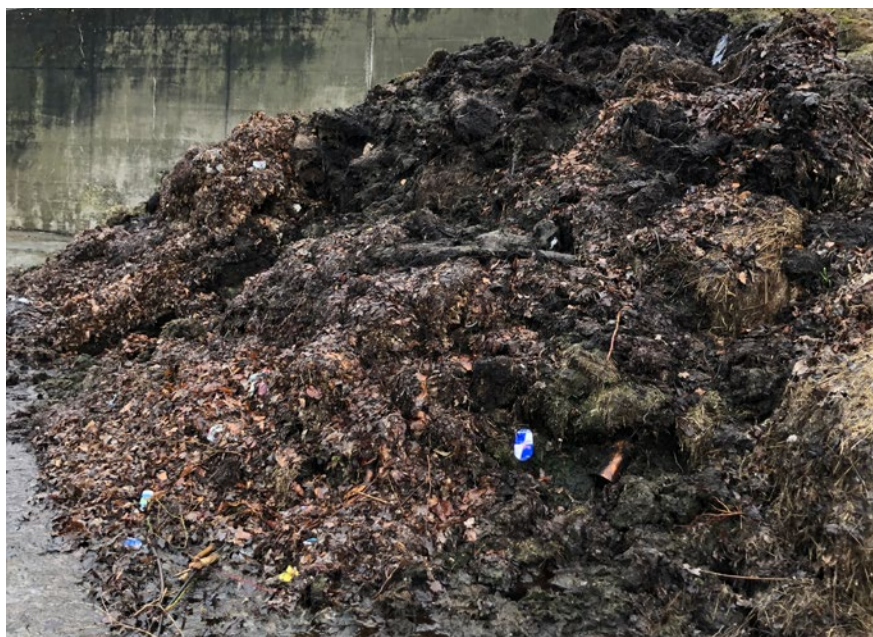
Foto 9: Fremdstoffe im Ausgangsmaterial können eine Ursache für eine nicht bestandene Inspektion werden. Wenn die Fremdstoffe nicht vor dem Prozess abgetrennt werden, ist es sehr schwer die Anforderungen zu den Fremdstoffgehalten im Produkt einzuhalten. Die Anlage mit diesem Ausgangsmaterial hat die Fremdstoffprobe nicht bestanden.
