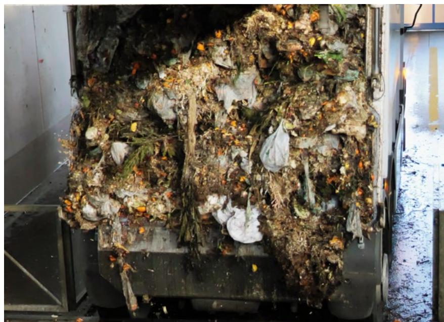
Foto 4: Ablad von Grüntour aus einem Kehrrichtsammelfahrzeug: Die Mengen an biogenen Abfällen aus den kommunalen Sammeldiensten nehmen zu, allerdings ist die Qualität bei einzelnen Lieferungen schlecht. Deshalb muss der Annahmekontrolle auch da mehr Bedeutung geschenkt werden, es laufen Versuche mit der fotografischen Aufnahme zur Qualitätskontrolle.
