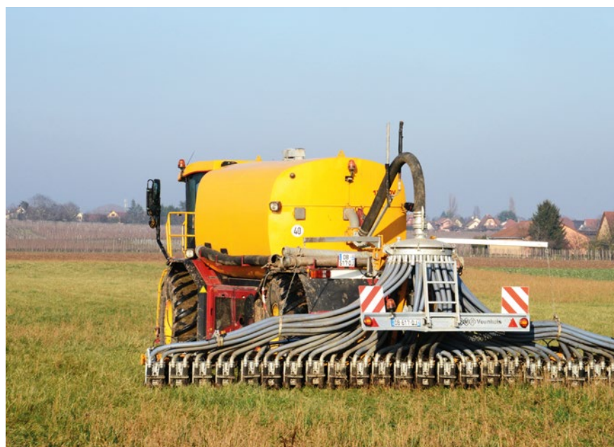
Foto 5: Schleppschlauch oder Schleppschuh bei der Ausbringung von flüssigen Vergärungsprodukten: Damit die Ammoniakverluste bei der Ausbringung von flüssigen Vergärungsprodukten reduziert werden, gibt es verschiedene technische Hilfsmittel. In Zeiten von steigenden Düngerpreisen werden solche Massnahmen auch wirtschaftlich interessant.
