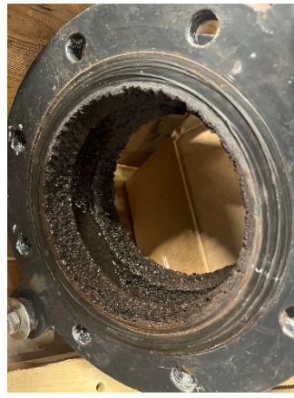
Abbildung 3: Verschlissener Kompensator saurer Wäscher
