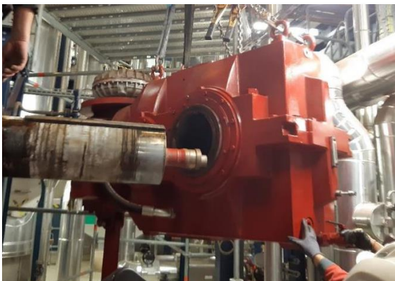
Abbildung 1: Demontage und Revision des Trocknergetriebes 1
