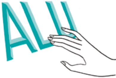
Buchstaben mit einer Höhe von 25 mm, hohem Kontrast und min. 1,7 mm Reliefhöhe sind gleichzeitig gut visuell und taktile erkennbar.
