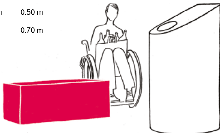
Ungeeignete oder schlecht platzierte Möblierung kann den Zugang zur Sammelstelle behindern.
