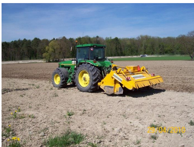
Einmischen des geschütteten Materials mittels Rotationspatenmaschine
