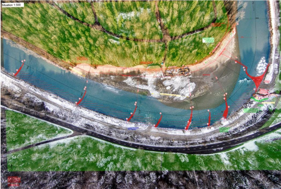
Eggrank mit Lenkbuhnen und Schneckenbuhne. Orthophoto mit eingezeichneten Buhnen.
