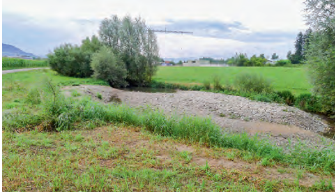
Eignung: Kies mit Sandanteil <20% ist gut geeignet (links). Sand, Schluff, Schlick und grosse Mengen an organischem Material sind nicht geeignet (rechts)
