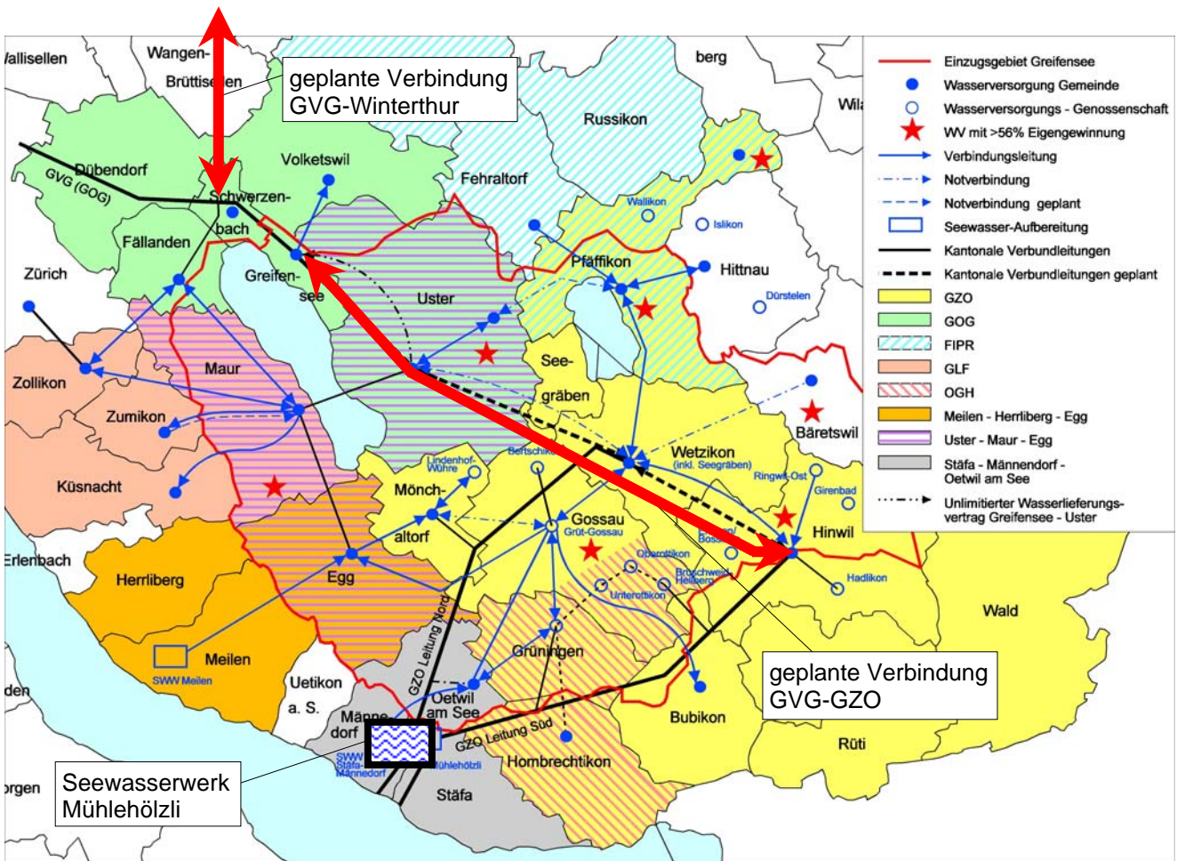
Bild 2: Leitungsverbindungen zwischen Gruppenwasserversorgungen und kommunalen Wasserversorgungen bzw. von kommunalen Wasserversorgung untereinander. Die roten Pfeile symbolisieren wichtige geplante Verbindungen des kantonalen Trinkwasserverbundes. Details siehe im "Trinkwasserverbund im Kanton Zürich", agw, Februar 1977.
