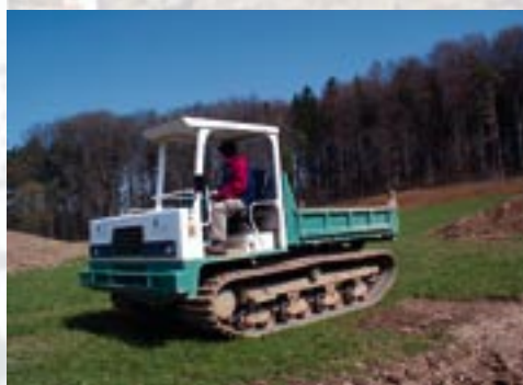
Der leichte Raupendumper kann auf dem gewachsenen Boden eingesetzt werden.
