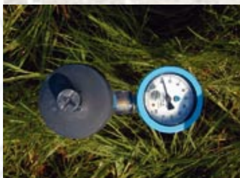
Tensiometer sind zur Überwachung der Bodentragfähigkeit und der Einsatzgrenzen unentbehrlich.
