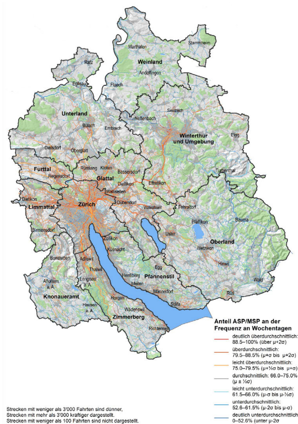
Abbildung 56: Stärke des Tagesgangs des Veloverkehrs an Wochentagen, dargestellt anhand des Verkehrsanteils in der Morgenspitze (MSP) bzw. Abendspitze (ASP)
