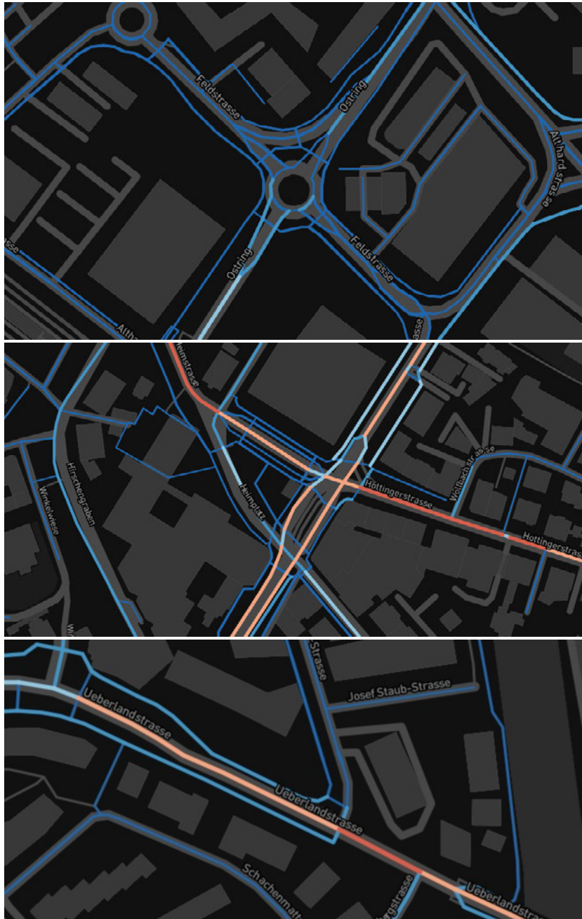
Abbildung 2: Komplizierte Netztopologie am Beispiel der Kreuzung Feldstrasse/Ostring in Regensdorf (oben) und am Heimplatz in Zürich (Mitte). Durch die Komplexität des Netzes entsteht jeweils eine Vielzahl von Unterknoten und Belastungen können sich – aufgrund der Genauigkeit der Positionsdaten mit einer gewissen Unsicherheit behaftet – auf mehrere parallele Achsen aufteilen. Beispiel: Sprunghafte Zunahme der Querschnittsbelastung auf der Überlandstrasse in Dietikon aufgrund der Reduktion der Netztopologie von drei parallelen Achsen zu einer Streckenachse (unten).
