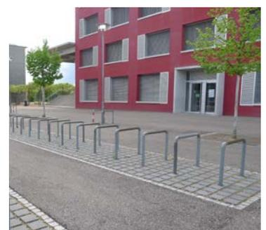
Anlehnbügel sind vandalensicher und einfach zu reinigen. Der Nachteil der fehlenden Überdachung wird bei dieser Anlage durch die optimale Lage und gute Gestaltung wettgemacht
