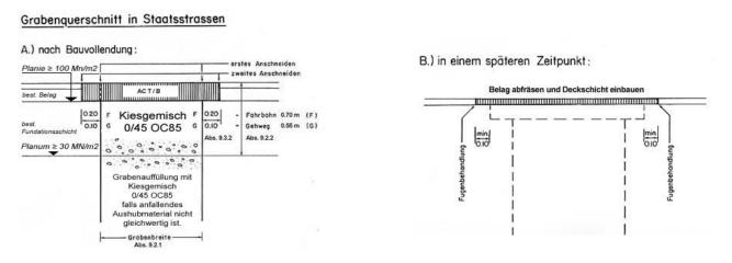
Für die Grabenauffüllung kann je nach Schutzzone nach Absprache mit dem Betriebsleiter des Unterhaltsbezirks auch Gemisch RCB 0/45 OC 85 verwendet werden.
