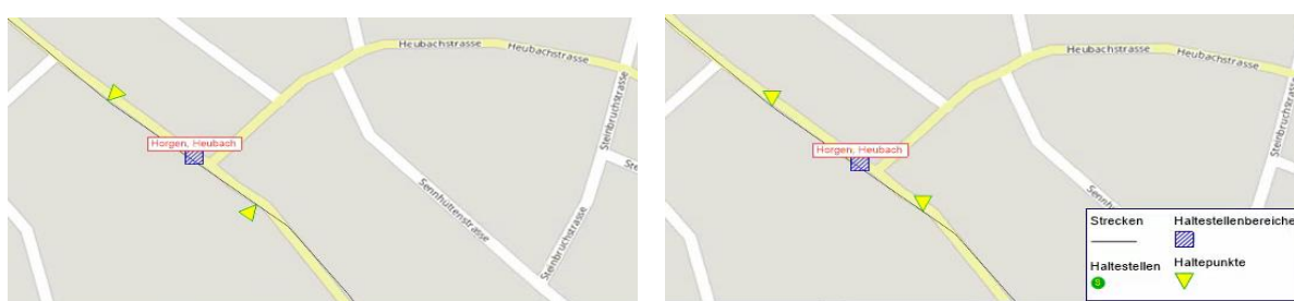
Abbildung 14 Haltepunkte gerichtet (links) und ungerichtet (rechts). Im linken Bild ist sofort zu erkennen in welcher Richtung die jeweiligen Haltepunkte angefahren werden können.
