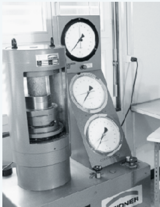
Strassenbaulabor, Zementstabilisierung, Prüfpresse, 1985. 103
